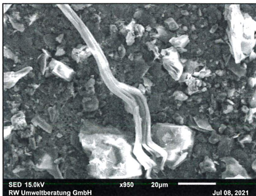
Bild 4: MP 23547-21, -24, -26 und -31, Chrysotil-Fasern
